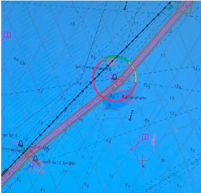
Figur 1. Bilden visar ett fartygs planerade rutt (orange korridor) vid insegling Flintrännan. Fartyget hade planerat en rutt över grund vilket, om det följts, skulle medfört grundkänning. I svart syns det spåret som fartyget seglade.
